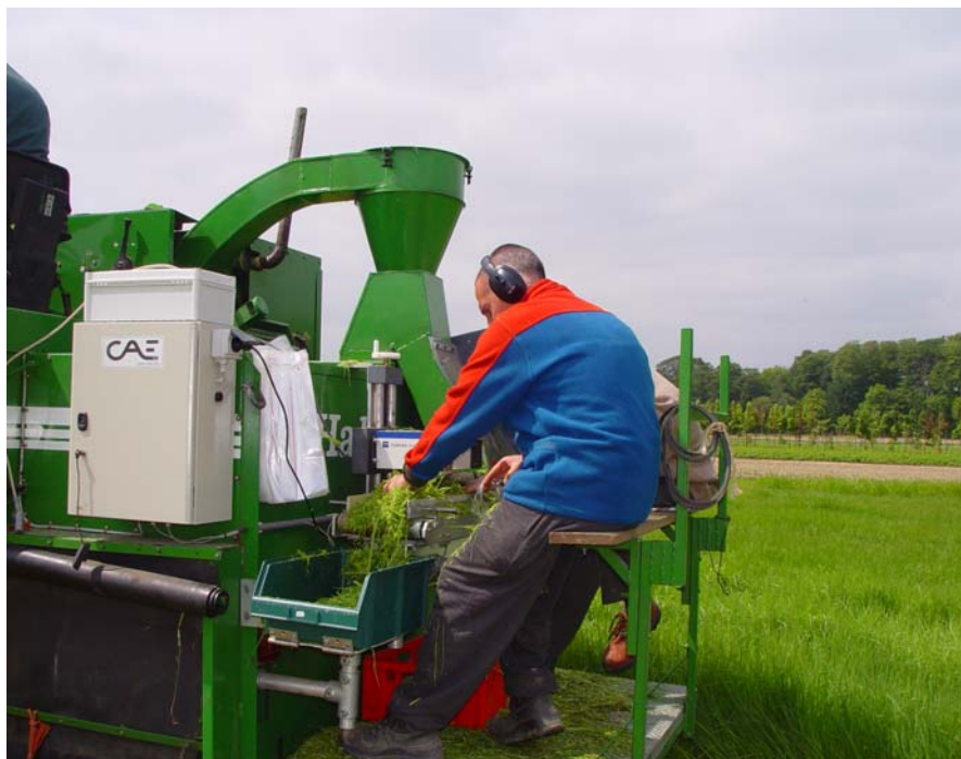
Figuur 5: On-line NIR metingen van gras bij het oogsten
