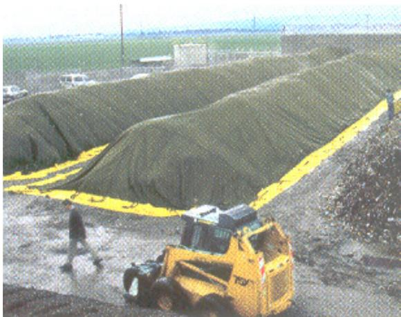
Es un sistema donde la pila de compost permanece estática a lo largo del proceso de compostaje. El aire se introduce a través de un sistema situado en el suelo bajo la pila. Con este sistema se eliminan las condiciones anaerobias ya que está asegurado un volumen constante de aire que además puede regularse a través de controladores según las necesidades de la masa.
