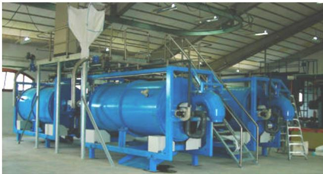
\*Reactor horizontal rotativo, con aireación en contracorriente e inclinación.
